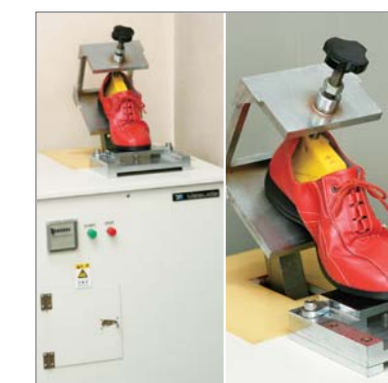
15 歩行屈曲試験機 靴(製品)の踏みつけ部分の耐屈曲性をテスト。 〈基準値〉10万回の屈曲後、異常がないこと。
