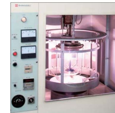
12 フェードメーター 紫外線による素材の変色・褪色等の度合いを検査。耐候試験。
