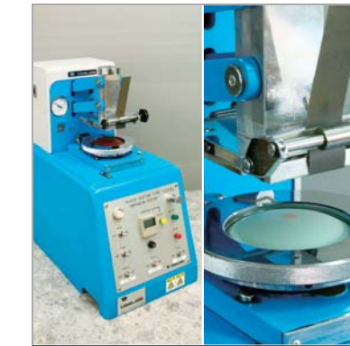
9 織物磨耗試験機 (カスタム式) 甲素材の磨耗強度を測定する試験機。素材の種類により異なる基準値(磨耗回数)を設けて測定。
