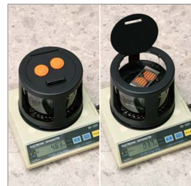
2 比重計 底材の比重を測定。表底磨耗試験の際に使用。
