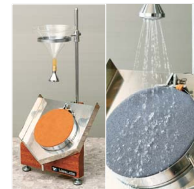
11 撥水試験機 甲素材の撥水度を測定。〈基準値〉80点以上
