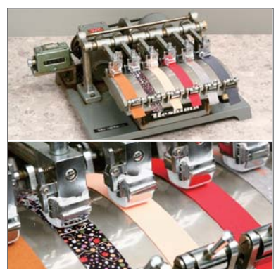
7 摩擦堅牢度試験機 染色生地との摩擦による色落ち度合いをテスト。 〈基準値〉乾式：4級以上 湿式：3級以上
