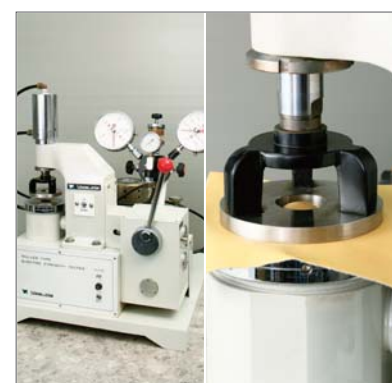
6 破裂試験機 甲素材が破れる力を測定する試験機。 〈破裂強さ〉基準値：1,000kPa 以上
