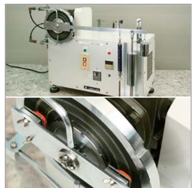
3 表底磨耗試験機 表底の耐摩耗性をテストする試験機。磨耗量を測定。 〈基準値〉ゴム底・EVA底：670cm 3 /kWh以下 塩ビ底・ウレタン底：400cm 3 /kWh以下
