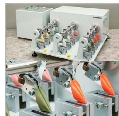
13 フレキシオメーター 甲素材の屈曲試験機。素材の種類により異なる規定回数 (合成皮革：5万回) の屈曲テスト後、表面樹脂層の亀裂状況を確認する。
