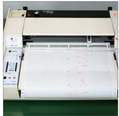
1 オートグラフ (データ出力) オートグラフで測定したデータを折れ線グラフで出力するプリンタ。
