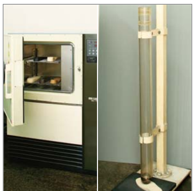
5 恒温槽 5 表底耐衝撃試験機 表底の耐寒性試験。表底をマイナス20℃の恒温槽に2時間入れた後、重さ1kgの鋼球を1mの高さから、ソール接地面に落下させて異常の有無をテスト。
