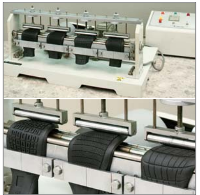
4 表底屈曲試験機 (ロスタイプ) 表底の耐屈曲性をテスト。10万回のテストで底に異常が生じないことが基準。
