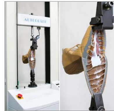
1 オートグラフ あらゆる種類の靴材について、強度や特性を測定することができる万能引っ張り試験機。
